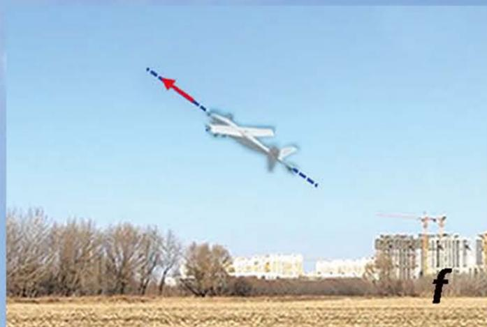
图 f 显示倾转三旋翼机斜向悬停在空中，同时沿着一根斜向直线飞行。
