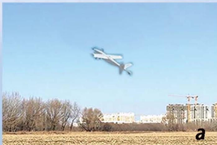
图 a 显示倾转三旋翼机处于一种斜向悬停状态。在这种状态下，飞机完全静止地斜向悬停在空中，没有任何姿态及位置的变化<sup>1,2</sup>。这种斜向悬停状态可以直接运用于很多飞行操作中，增强飞机的任务执行能力。例如航拍，航测。这种斜向悬停状态还构成了飞机其他一些特殊飞行方式的基础。
